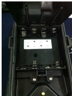
Korrekte Batterielage Batterieebenfach geöffnet
