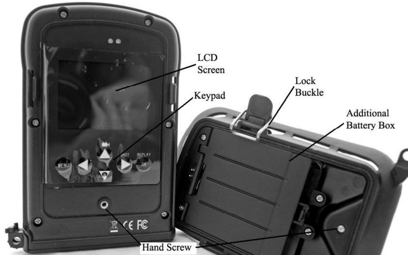
Kamera Rückseite mit Batteriezusatzfach/Kamerahalterung
