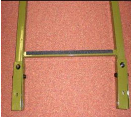
Montieren Sie 4 Winkel Nr. P mit dem verbliebenem Leiterteil ohne Fußstützen Nr. A2.
